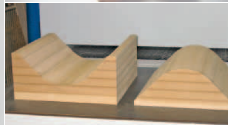
Eine positive und eine negative Pressschablone aus MDF
